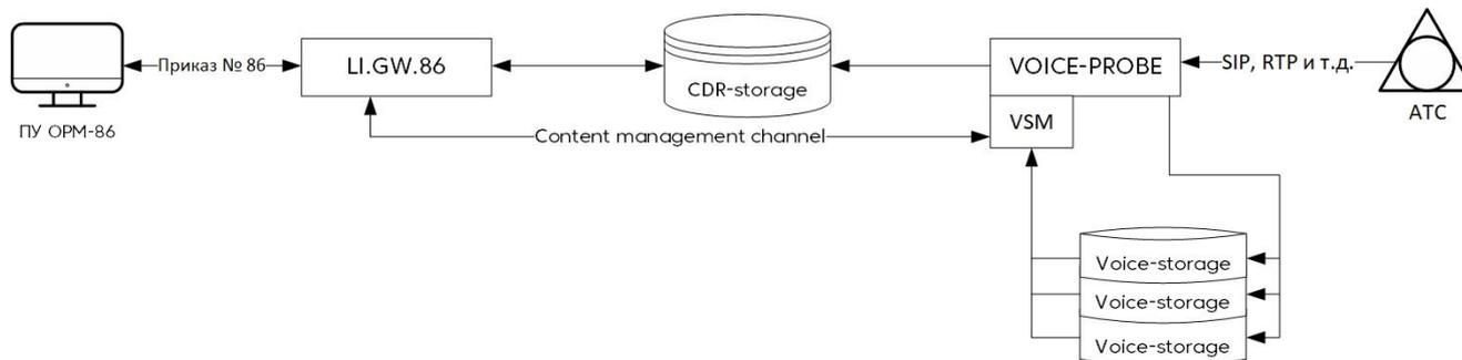
Рисунок 1 — Внутренняя архитектура ПАК ЯКОРЬ-DMR-ТФ
